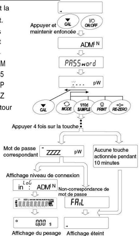
3. Si le mot de passe est correct, le niveau de connexion est affiché et le pesage est affiché une fois tous les témoins allumés. (Dans les réglages d'usine, le mot de passe est **ZZZZ** et est saisi en appuyant 4 fois sur la touche **RE-ZERO** (remettre à zéro) au niveau administrateur.) Si le mot de passe est incorrect, la sonnerie retentit 3 fois dans l'affichage **FaiL** (échec) et l'affichage s'éteint.
