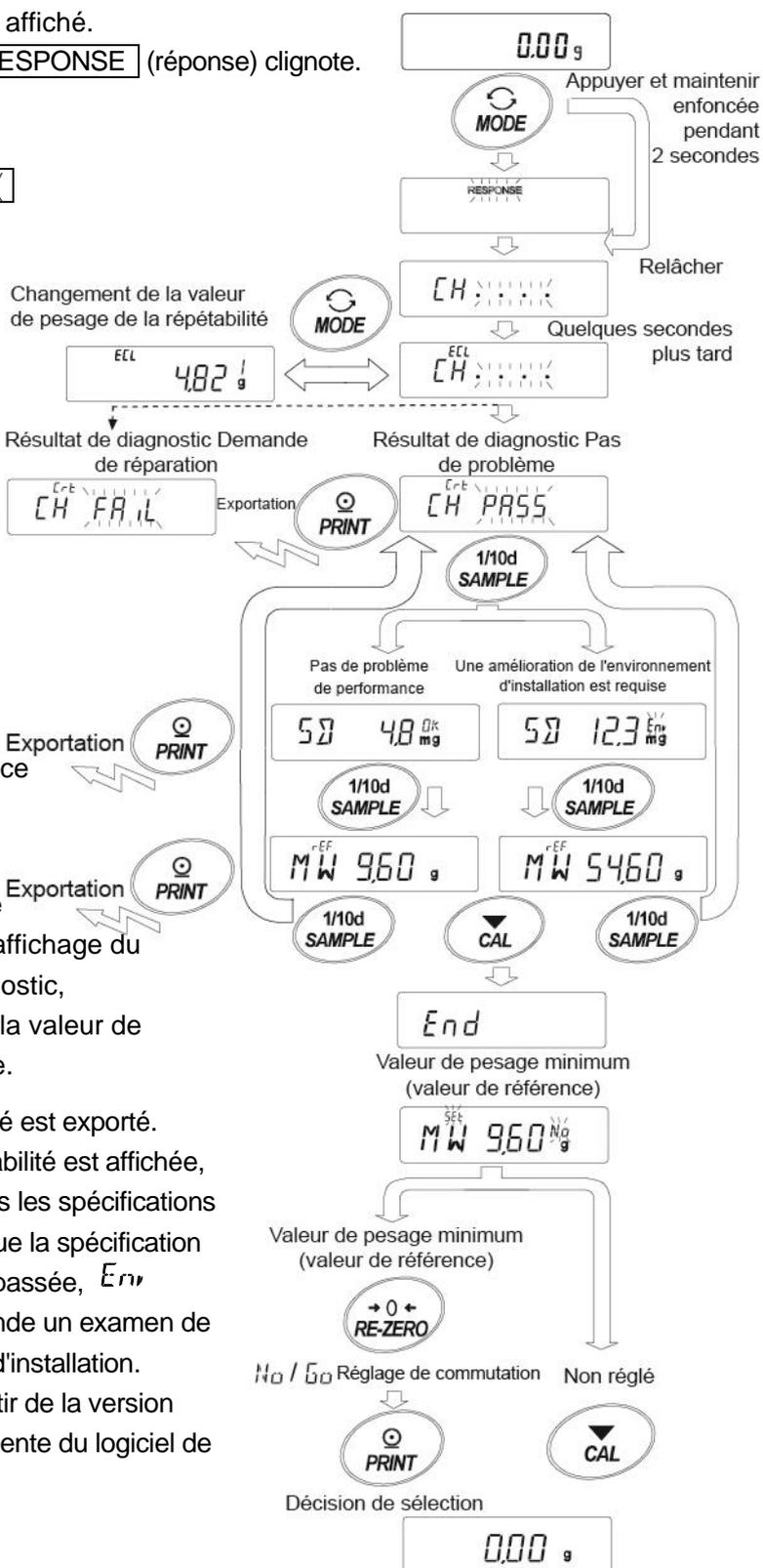
5. Appuyer sur la touche **CAL** (étalonner) pour afficher **End** (fin) et passer à l'affichage pour l'enregistrement de la valeur de pesage minimale.
