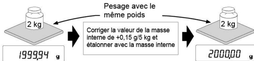
Après l'étalonnage en une opération, placer le poids externe sur la balance et contrôler la valeur de correction.
