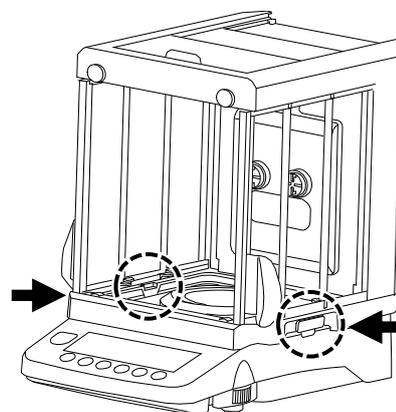
Appuyer sur les leviers de verrouillage gauche et droit pour fixer la protection contre les courants d'air à la balance.
