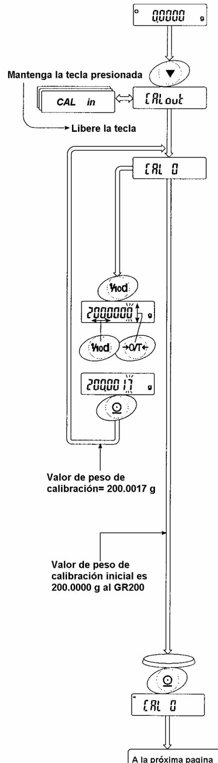
Paso 6 - Coloque el peso (o masa) de calibración desplegado en el plato de pesado y presione la tecla PRINT. La balanza despliega el peso de calibración medido. Prevenga que vibraciones o corrientes de aire afecten a la balanza
