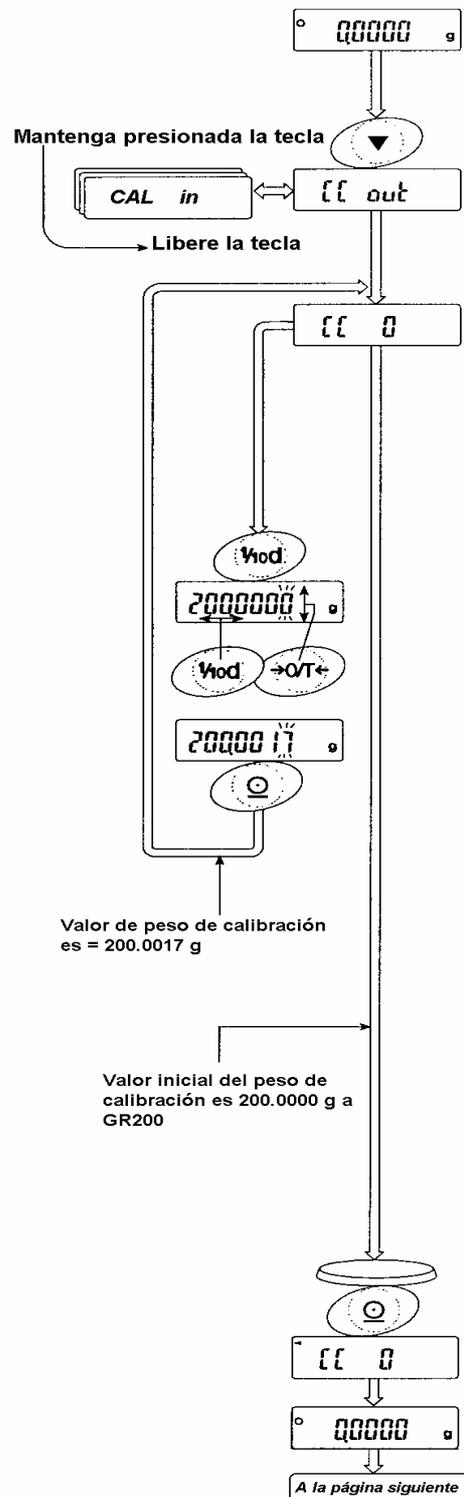
Paso 6 - Coloque el peso objetivo desplegado en el plato de pesado y presione la tecla PRINT. La balanza despliega entonces el peso objetivo medido. Prevenga que vibraciones y corrientes de aire afecten a su balanza
